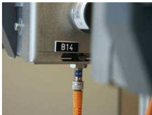
Détecteurs inductifs de prise d'origine sur l'axe Y
