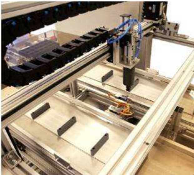
Préhenseur et convoyeurs à taquets
